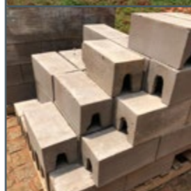
Blocos de concreto produzidos a partir de rejeito de minério
